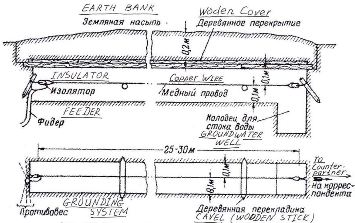
Рис. 149. Вариант размещения траншейной антенны
