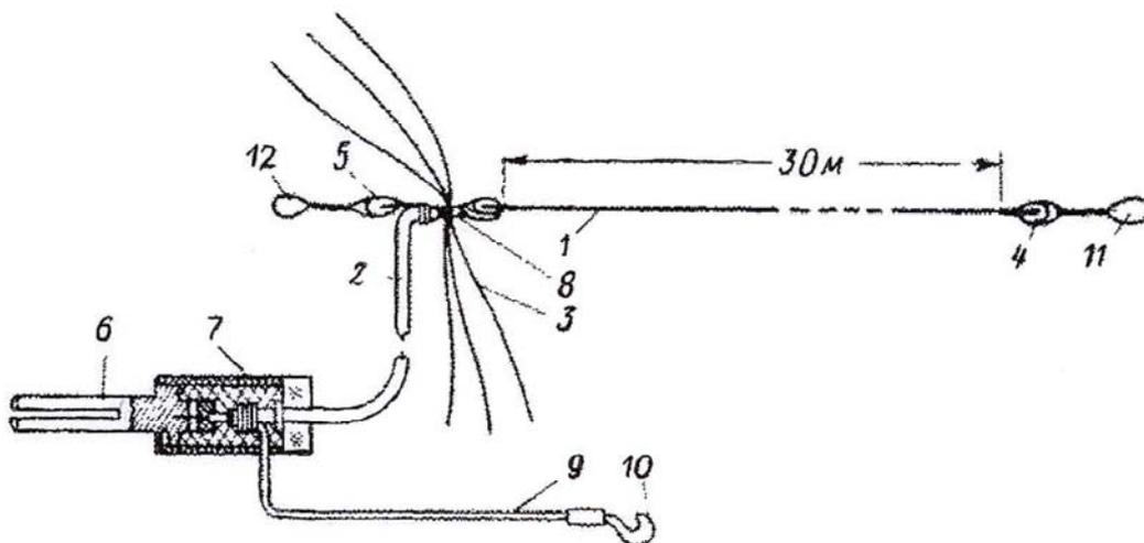
Рис. 148. Конструкция траншейной антенны
