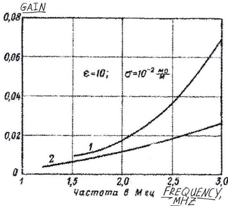
Рис. 145. Частотная зависимость коэффициента усиления по земной волне:
