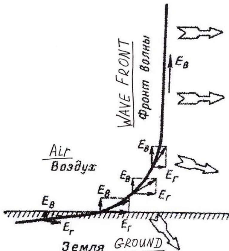
Рис. 131. Изменение наклона волны у поверхности земли
